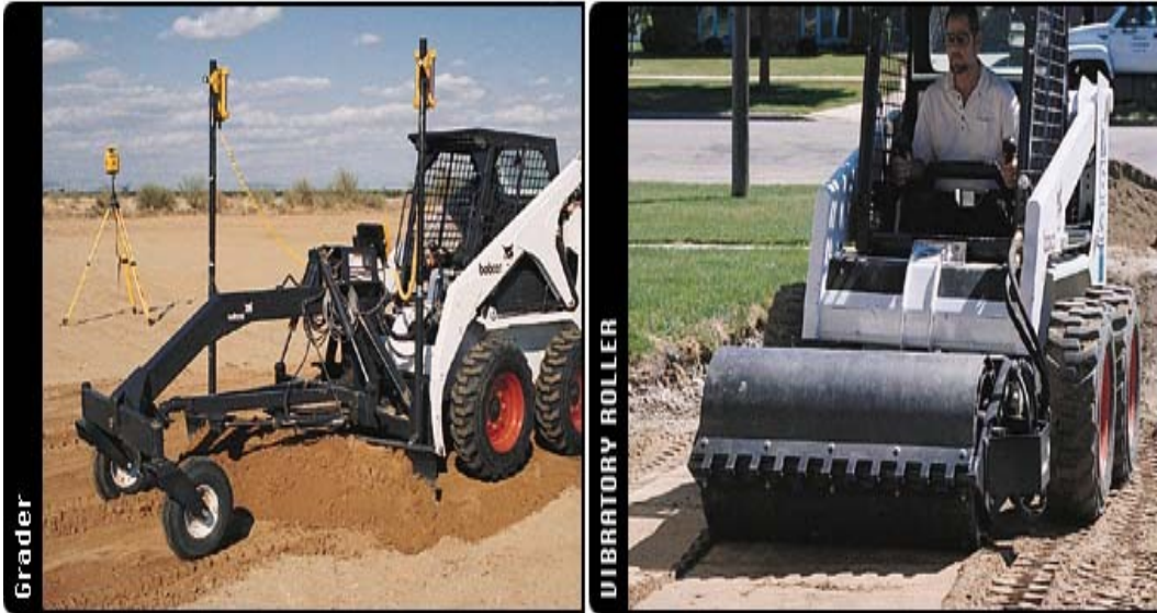
Niveladora Rodillo Vibrador
