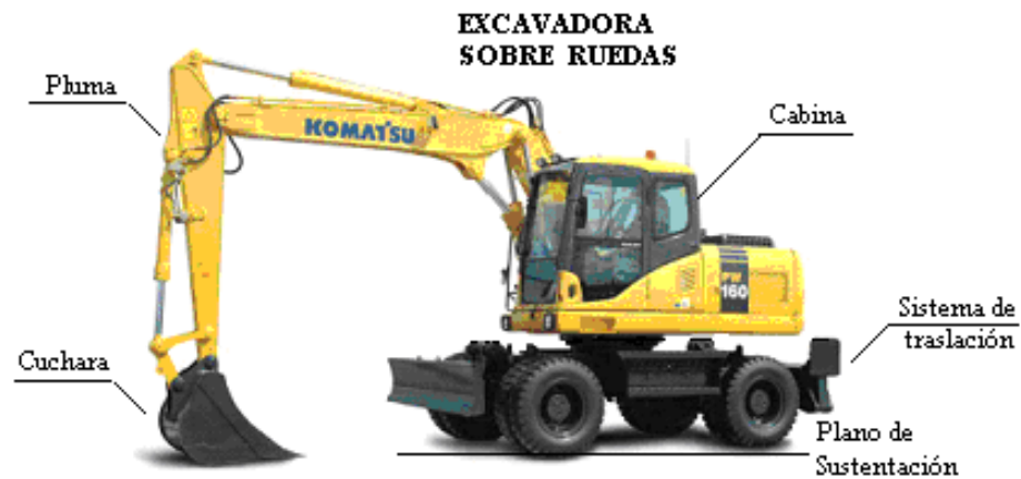
FIGURA 3-1: Excavadora sobre Ruedas
