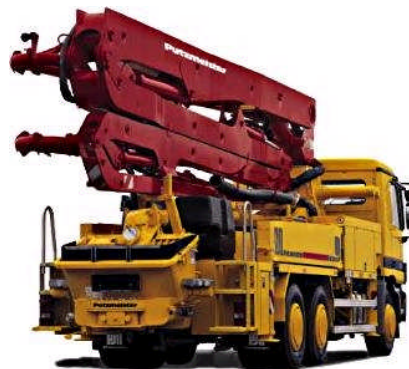
FIGURA 12-6: Camion Auto bomba para Hormigon
