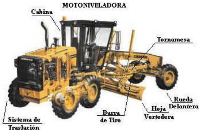
FIGURA 11-1: Partes Motoniveladora
