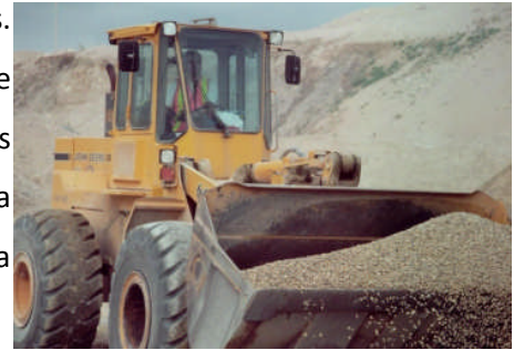
FIGURA 3-3:Excavadora o pala cargadora con ruedas
